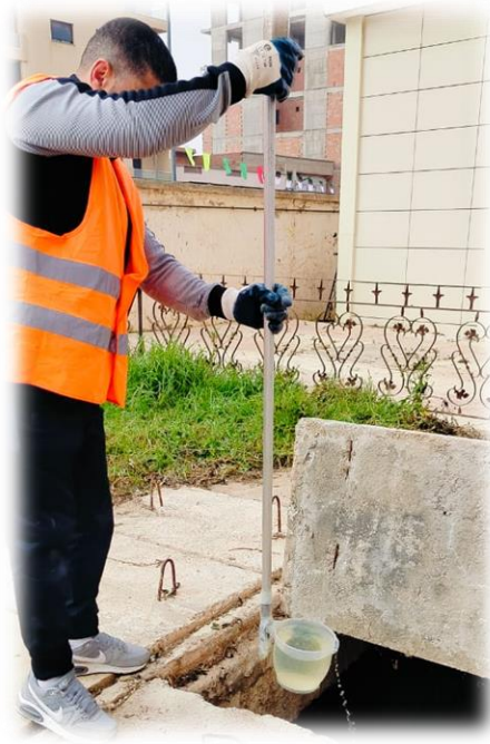
Figure 6 : Prélèvement d'effluent liquide dans un collecteur terminal d'un hôpital.
